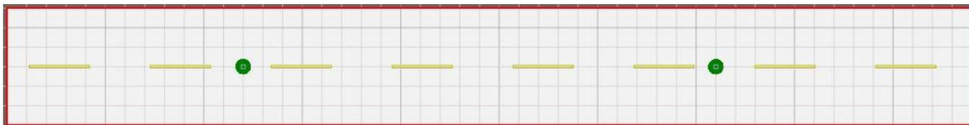
**Steuerung:** Bewegungsabhängiges Schalten mit Tageslichtregelung, Orientierungslichtfunktion mit einstellbarer Nachlaufzeit
